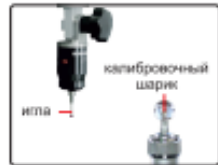
датчик (опция), включает в себя иглы Ø2 мм и Ø3 мм, калибровочный шарик Ø25 мм, точность измерения 10 мкм
